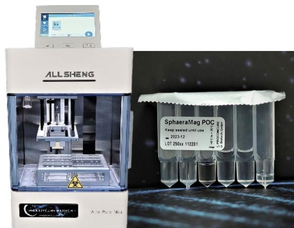
PhoenixDx® POC ist ein kompaktes all-in-one qPCR Analysegerät, das in den analysierten Proben mit Hilfe spezieller Reagenzien durch die Vervielfältigung der enthaltenen Erbsubstanz (Polymerase Chain Reaction – PCR) das Vorhandensein bestimmter Erreger nachweisen kann.
