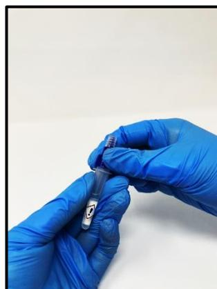
4. Schütteln Sie den Isolationspuffer im Röhrchen, um das Material homogen zu verteilen (z.B. mit Vortex Mixer – siehe **4.2 Mischen der Probe mittels Vortex Mixer**). Warten Sie, bis sich möglicher Schaum im Röhrchen aufgelöst hat, bevor Sie weiterarbeiten
